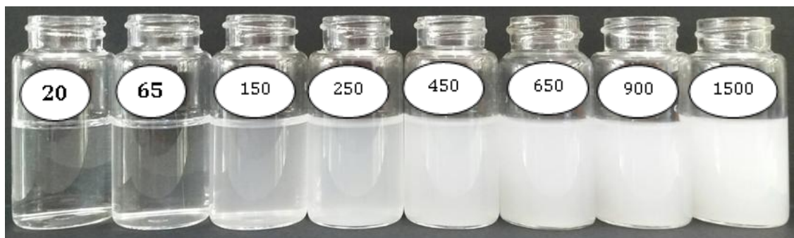
ภาพที่ 4 ชุดเทียบสีโพแทสเซียมที่ความเข้มข้นตั้งแต่ 20-1500 มก./กก.
