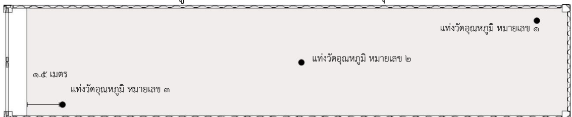
ภาพที่ ๑ ตำแหน่งการวางถังวัดอุณหภูมิผลไม้ภายในตู้ขนส่งสินค้าสำหรับการกำจัดศัตรูพืชด้วยความเย็นระหว่างขนส่ง
