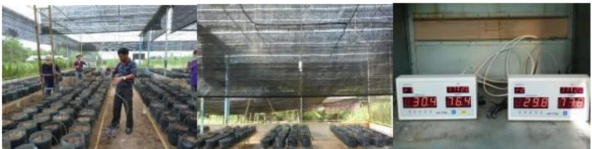
ภาพที่ ๖ การติดตั้งเครื่องมือวัดอุณหภูมิและความชื้นสัมพัทธ์แบบอัตโนมัติ
