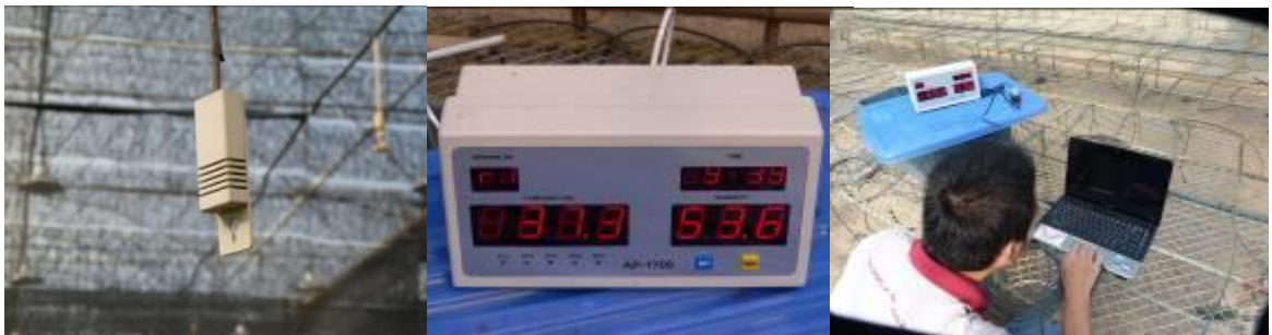
ภาพที่ ๕ การทดสอบเครื่องมือวัดอุณหภูมิและความชื้นสัมพัทธ์แบบอัตโนมัติ
