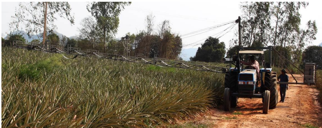
รูปที่ ๑๒ เครื่องลำเลียงผลสับปะรดขณะทำงานบนพื้นที่เนินเขา
