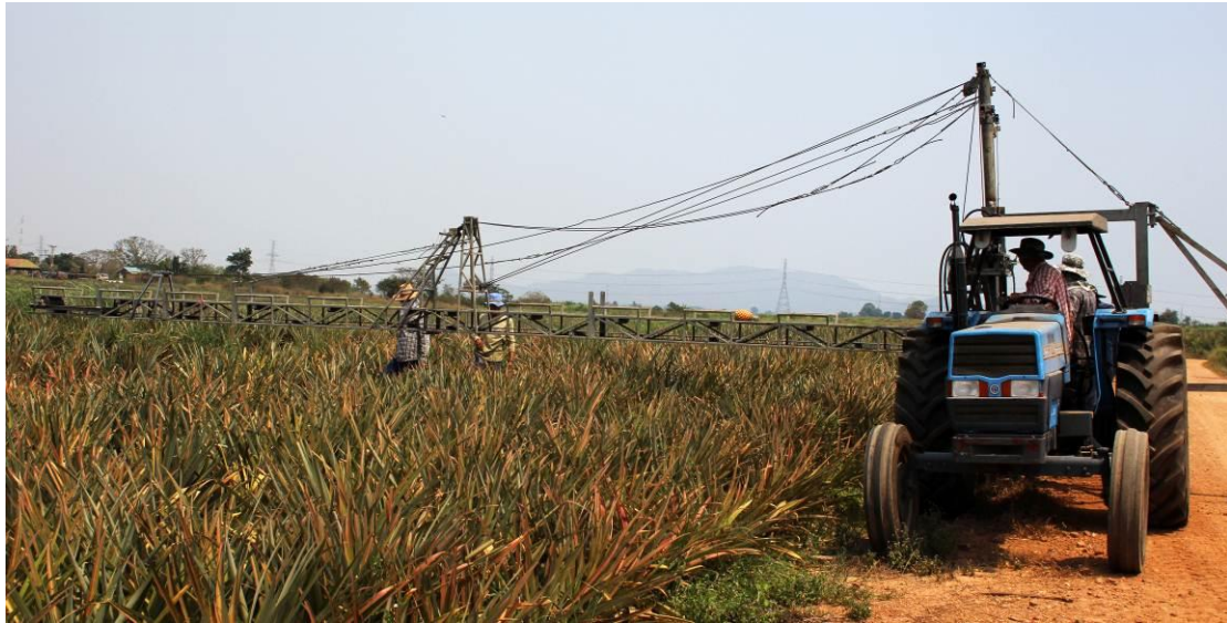
รูปที่ ๑๑ เครื่องลำเลียงผลสับปะรดขณะทำงาน
