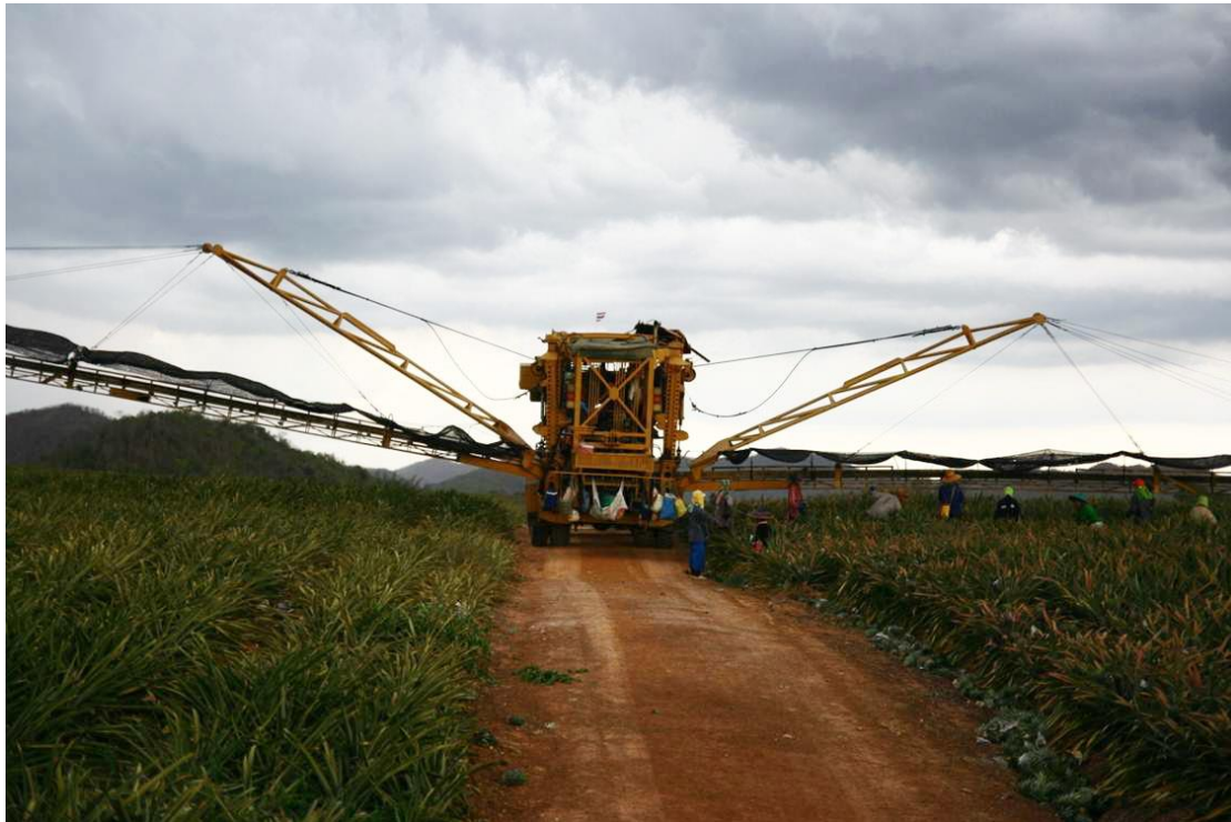
รูปที่ ๔ เครื่องลำเลียงผลสับปะรดของโรงงานแปรรูปสับปะรด
