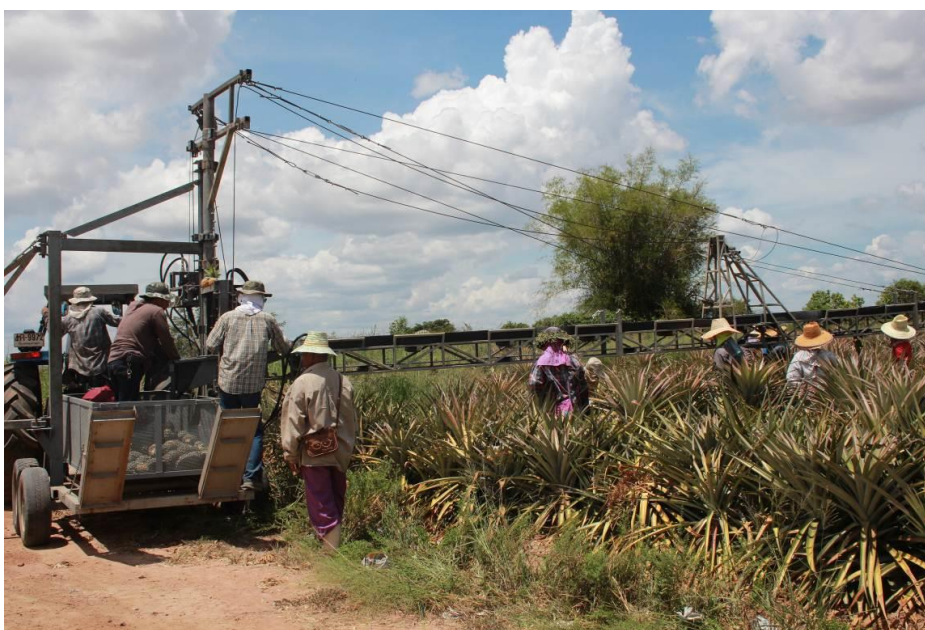
รูปที่ ๑๕ เครื่องลำเลียงผลสับปะรดขณะทำงานในแปลงสับปะรดแบบโรงงาน (ด้านหลัง)
