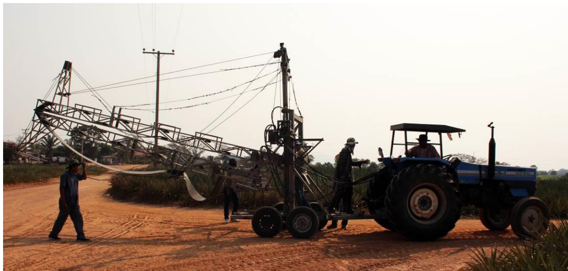
รูปที่ ๑๐ เครื่องลำเลียงผลสับปะรดขณะเดินทาง
