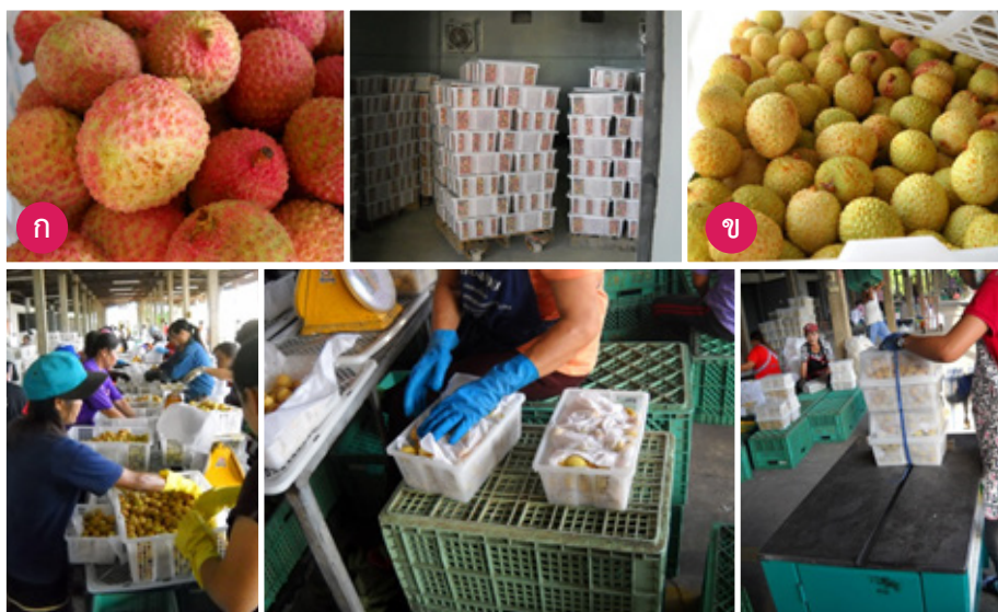
ภาพที่ 5.5 : ขั้นตอนการรมซัลเฟอร์ไดออกไซด์ผลล้นจี๋ สีสีก่อนรม (ก) และหลังรมจะมีสีเหลือง (ข) และกระบวนการคัดบรรจุส่งออกกะวันออกกลางและยุโรป
