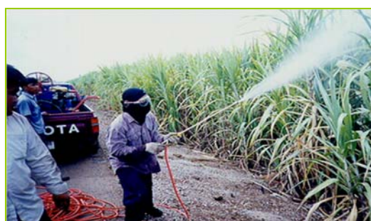
เครื่องพ่นสารไกลโฟเสทแบบเครื่องยนต์ มีสายส่งสารเคมี สามารถพ่นสารไกลโฟเสทได้ไกล
