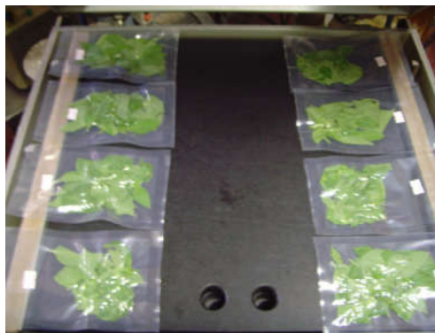
ปิดผนึกบรรจุภัณฑ์ด้วยเครื่องปิดผนึกสุญญากาศ แช่แข็งที่อุณหภูมิ -28^{\circ}\text{C} เป็นเวลา 30 นาที
