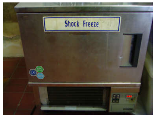
ปิดผนึกบรรจุภัณฑ์ด้วยเครื่องปิดผนึกสุญญากาศ แช่แข็งที่อุณหภูมิ -28^{\circ}\text{C} เป็นเวลา 30 นาที
