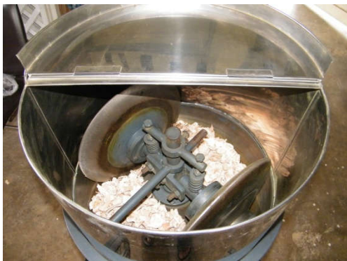
ภาพ เครื่องบดที่ใช้ในการบดกล้วยแห้ง
