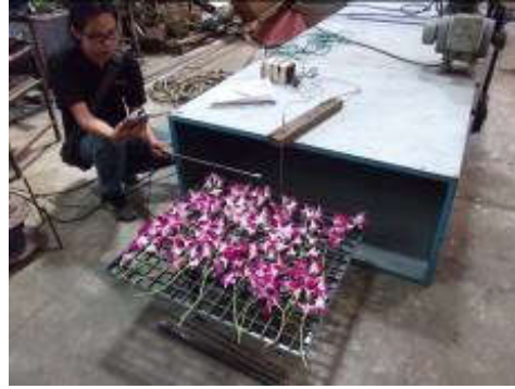
รูปที่ 20. ทดสอบระบบลดความชื้นช่อดอกกล้วยไม้ต้นแบบ
