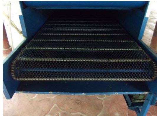
รูปที่ 2. ติดตั้งตาข่ายพลาสติกบนชุดลำเลียง
