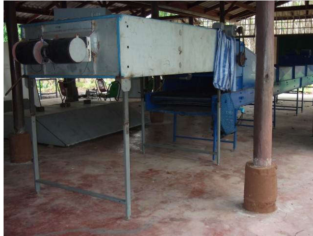
รูปที่ 27. เครื่องลดความชื้นกล้วยไม้แบบอุโมงค์ลมมีระบบลดความชื้นแบบปั๊มความร้อนต้นแบบ
