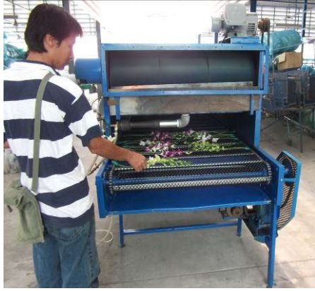
รูปที่ 6. ทดสอบลดความชื้นช่อดอกกล้วยไม้
