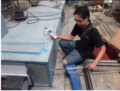
รูปที่ 19. วัดอุณหภูมิและความเร็วลมของอากาศ
