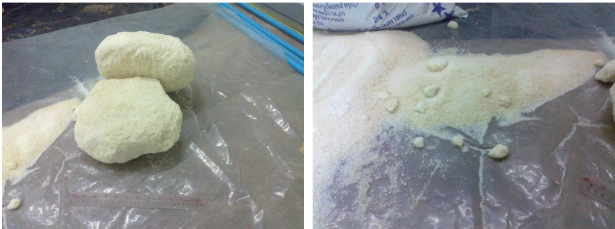
รูปที่ 9.7 ลักษณะของปุ๋ยที่มีการจับตัวกันเป็นก้อน
