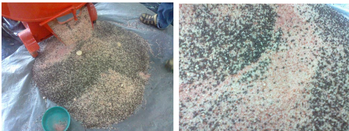
รูปที่ 9.7 ลักษณะของปุ๋ยที่มีการจับตัวกันเป็นก้อน
