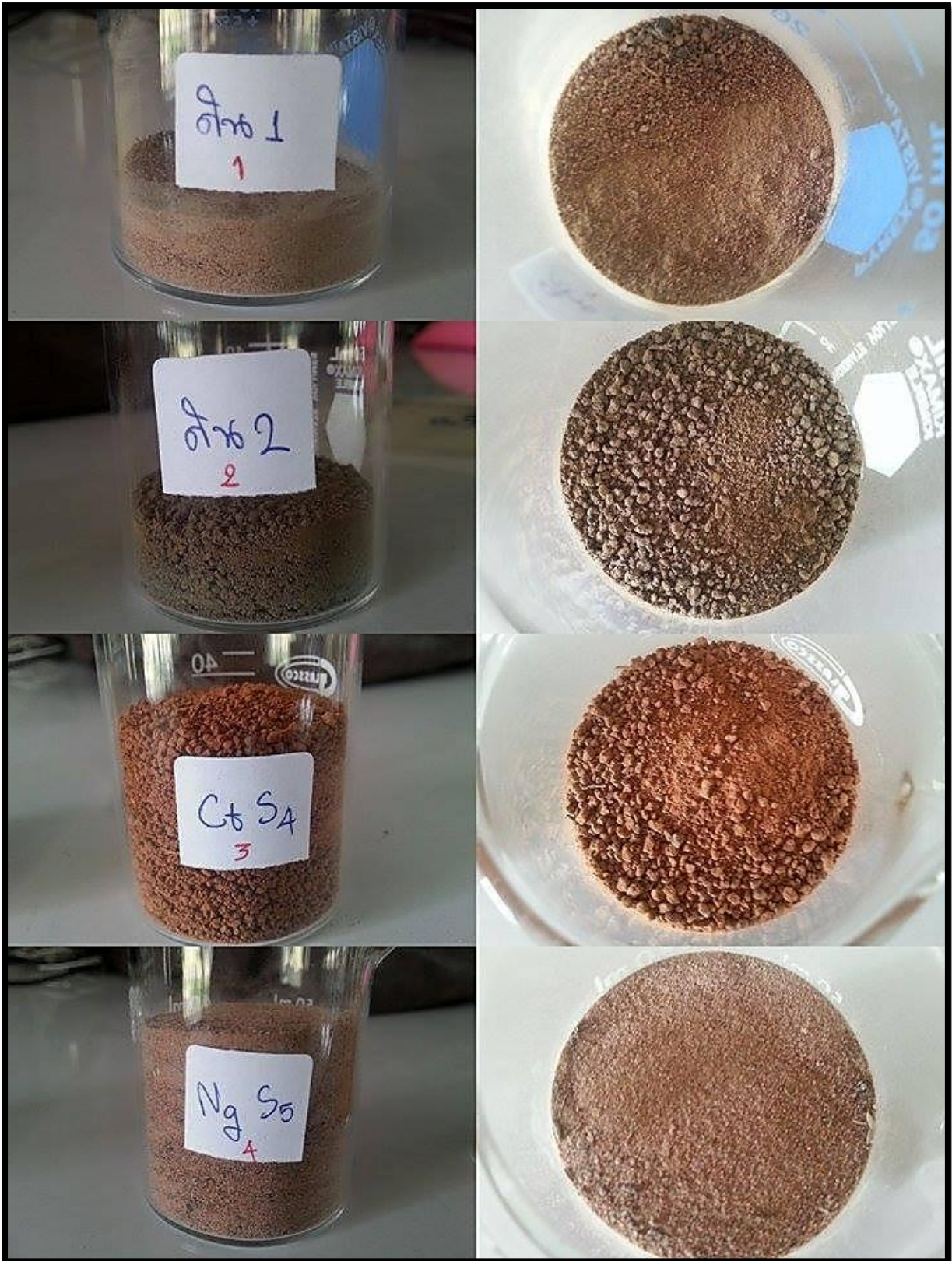
รูปที่ 9.21 ชนิดดินที่ทำการวิเคราะห์ในห้องปฏิบัติการและทราบค่าในการวิเคราะห์เพื่อนำมาใช้ในการวิเคราะห์ร่วมกับชุด KIT
