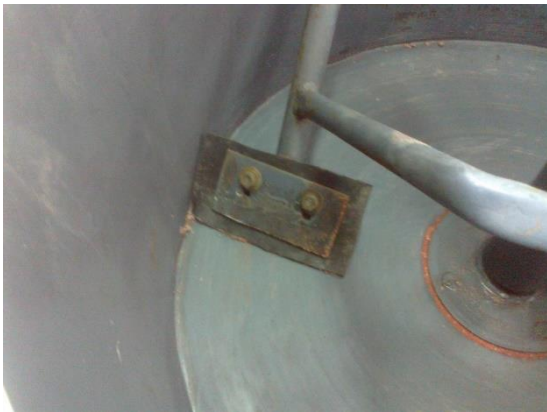
รูปที่ 9.10 การปรับปรุงเครื่องผสมปูนให้เป็นเครื่องผสมปุ๋ยโดยการใส่แผ่นยางที่ใบกวน
