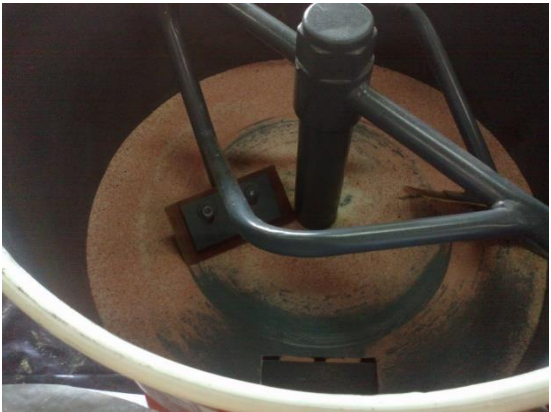
รูปที่ 9.10 การปรับปรุงเครื่องผสมปูนให้เป็นเครื่องผสมปุ๋ยโดยการใส่แผ่นยางที่ใบกวน
