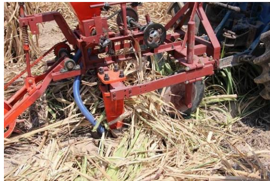
รูปที่ 3 การทดสอบการทำงานเบื้องต้น ใบอ้อยสะสมเนื่องจากสับใบไม่ขาด
