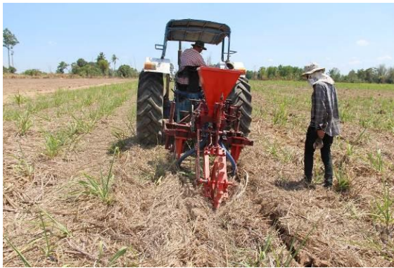
รูปที่ 3 การทดสอบการทำงานเบื้องต้น ใบอ้อยสะสมเนื่องจากสับใบไม่ขาด
