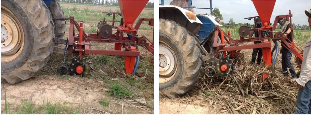
รูปที่ 5 ทดสอบใบตัดแบบกองจักรที่สร้างขึ้นใหม่ในแปลง
