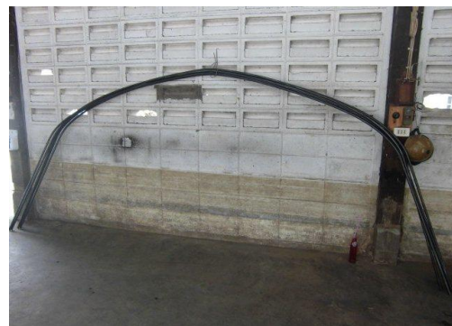
รูปที่ 10 โครงท่อเหล็กที่ได้จะมีขาเฉียงเนื่องจากการติดคินตัวของเมื่อแกะออกจากแม่แบบ
