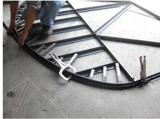
รูปที่ 6 ช่วงที่ติดท่อเหล็กแนบกับแม่แบบแล้ว ให้จับยึดไว้ด้วยเครื่องมือสำหรับล๊อค
