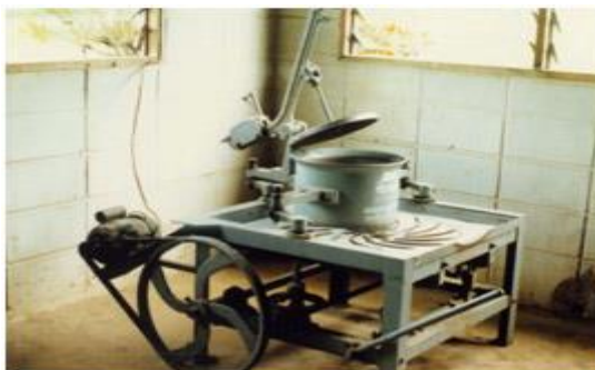
รูปที่ 4 เครื่องนวดชาชนิดทรงกระบอก
