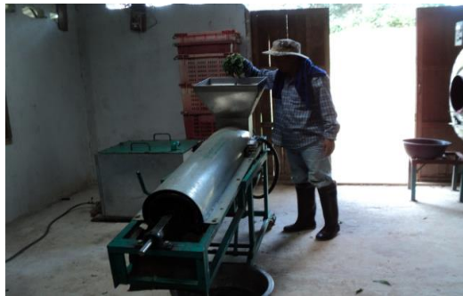
รูปที่ 2 เครื่องอบไอน้ำ รุ่นตามแบบกองเกษตรวิศวกรรม
