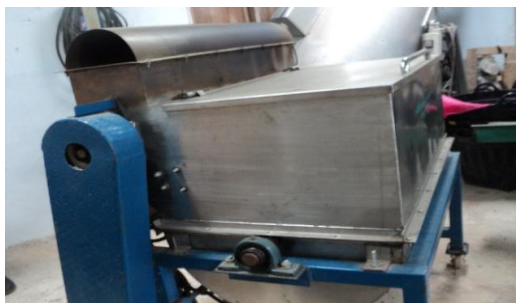
รูปที่ 3 เครื่องนวดและอบไอร้อน รุ่นตามแบบกองเกษตรวิศวกรรม
