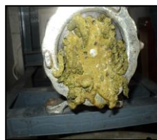
รูปที่ 10 เครื่องตัดยอดชาสด (ดัดแปลงจากเครื่องบดเนื้อ)
