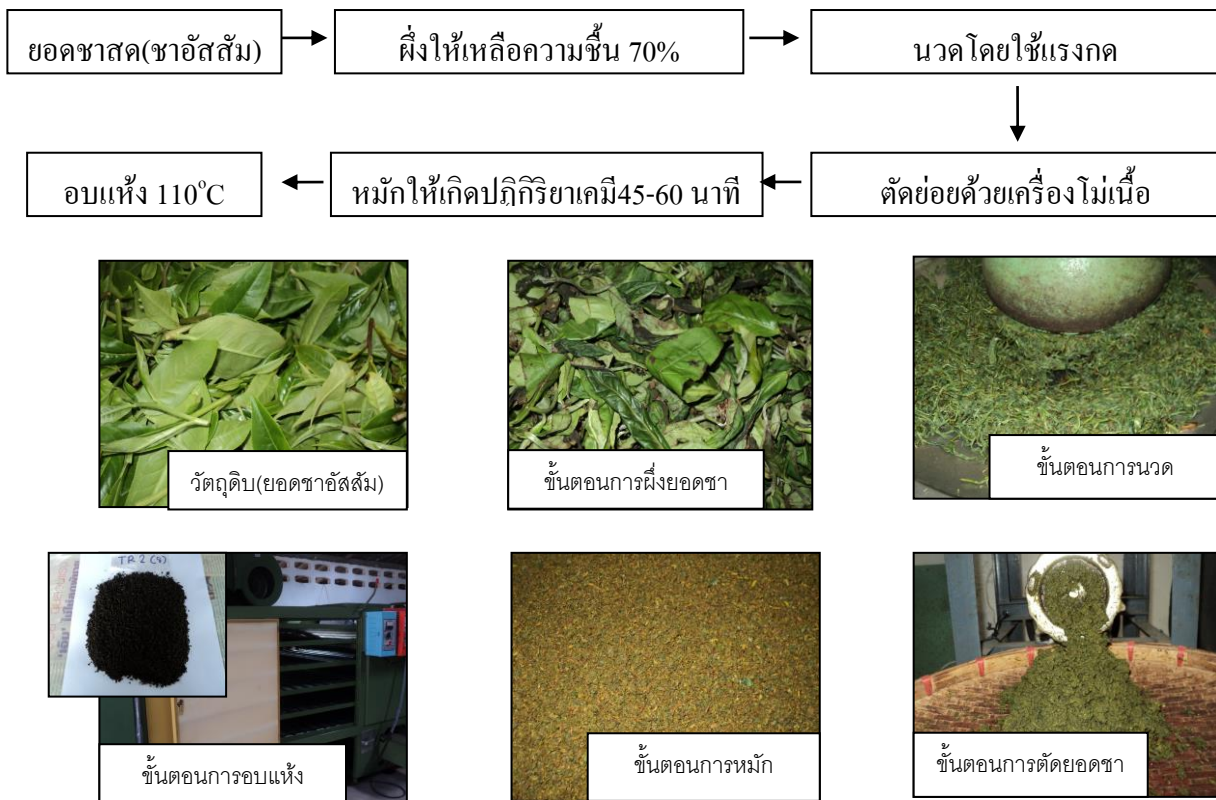
รูปที่ 21 ขั้นตอนการแปรรูปผลิตภัณฑ์ชาฝรั่งด้วยยอดชาอัสสัม
