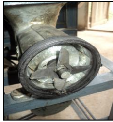
รูปที่ 4 เครื่องตัดขอดีชาสด(ดัดแปลงจากเครื่องโม่เนื้อ)
