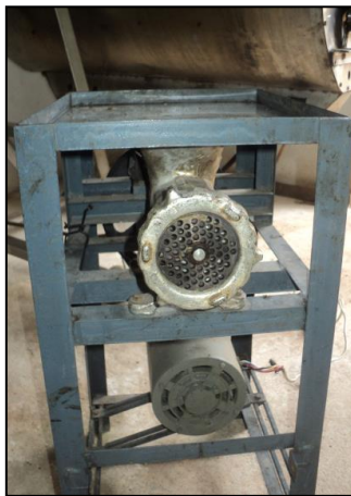
รูปที่ 10 เครื่องตัดยอดชาสด (ดัดแปลงจากเครื่องบดเนื้อ)
