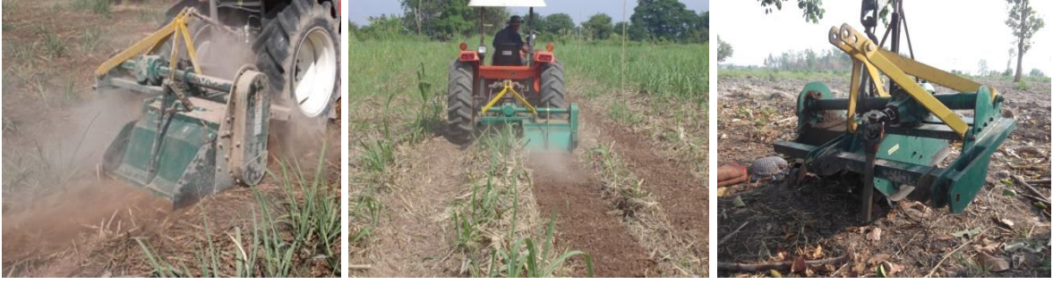
รูปที่ 2.รถแทรกเตอร์ขนาด 45 แรงม้า พร้อมพ่วงอุปกรณ์จอบหมุนที่ใช้ในการสับกลบใบอ้อย
