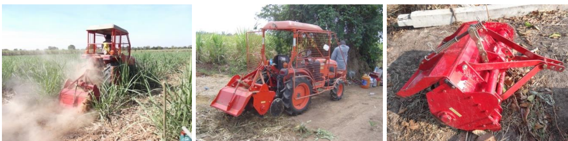
รูปที่ 1.รถแทรกเตอร์ขนาด 24 แรงม้า พร้อมพวงอุปกรณ์จอบหมุนที่ใช้ในการสับกลบใบอ้อย
