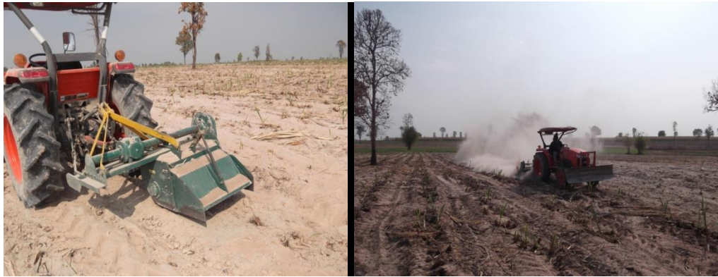
รูปที่5 การใช้จอบหมุนเพื่อการเจียรตออ้อยหลังการตัด
