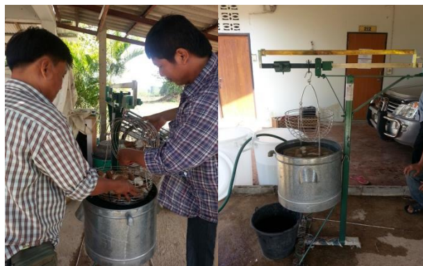
(จ) บันทึกข้อมูลปริมาณแป้งด้วยเครื่องวัดปริมาณแป้งเพื่อนำไปคำนวณผลผลิตแป้ง
