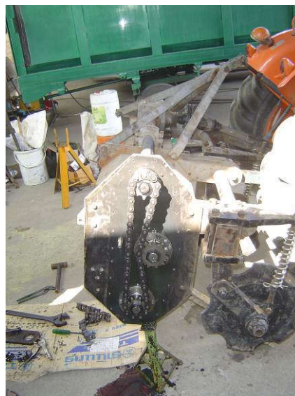
รูปที่ 11 แสดงการใช้โซ่ขับเคลื่อนสวนกัน
