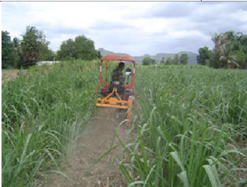
รูปที่ 20 แสดงผลการทำงานเครื่องสับใบอ้อยพ่วงแทรกเตอร์ 24 แรงม้า
