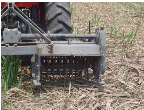
รูปที่ 4 รูปแบบการส่งกำลังจากรถแทรกเตอร์ไปยังเพลาลูกตี่
