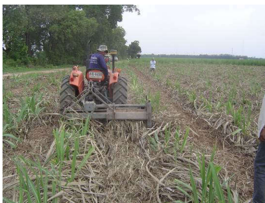
รูปที่ 6 แสดงการใช้แทรกเตอร์ขนาด 34 แรงม้าพวงเครื่องสับใบอ้อยและใบอ้อยเข้ามาพันแกนลูกตี
