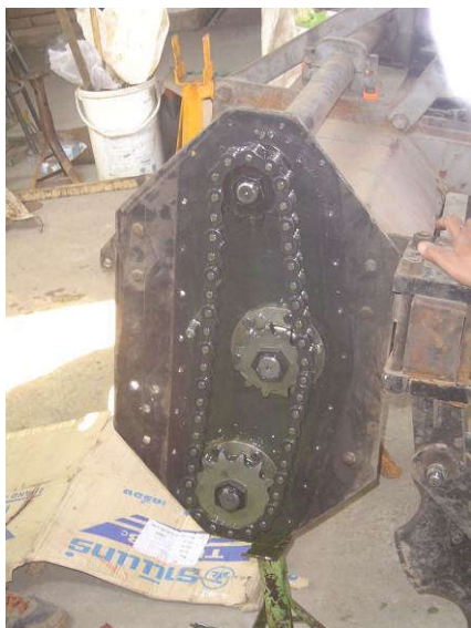
รูปที่ 10 แสดงการใช้โซ่ขับเคลื่อนตามกัน
