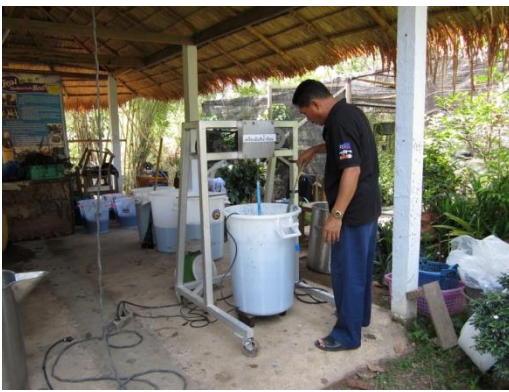
(ค) กรองเอาเศษห้อมออก นำไปตีด้วยเครื่อง 12 นาที เติมปูนขาว 120 กรัมต่อห้อม 1 กิโลกรัม
