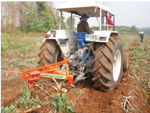
เครื่องชุดแบบไถหัวหมูต้นแบบ กับแทรกเตอร์ 80 แรงม้า เกือบเกี่ยวในดินร่วน-เหนียว
