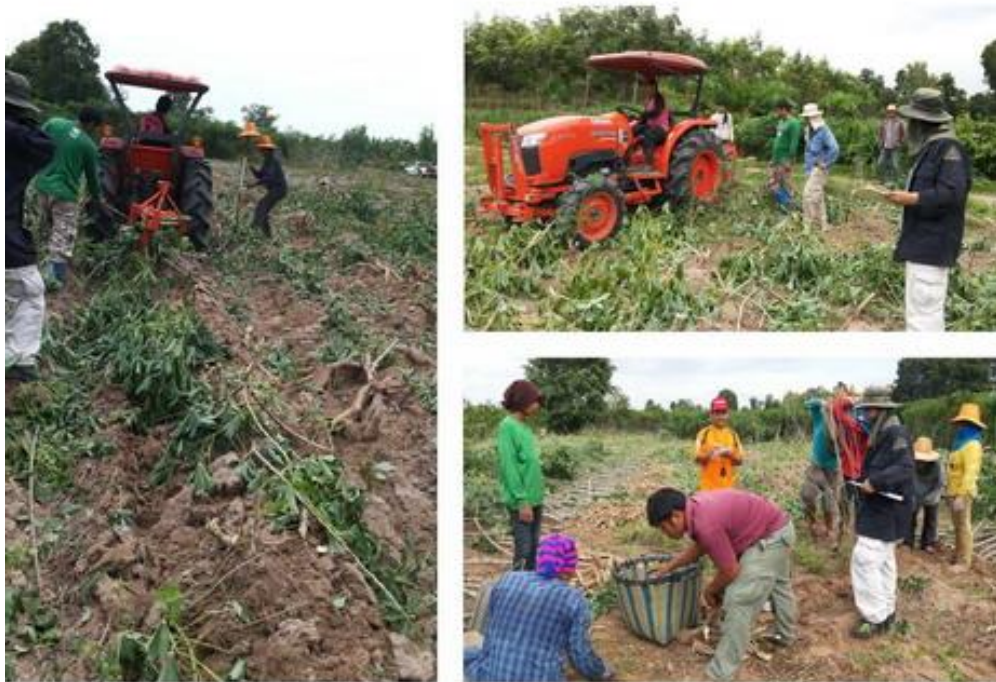
ภาพที่ 2 การทดสอบเครื่องชุดหัวมันสำปะหลัง ในแปลงนายสมจิต ถิ่นวิมล
