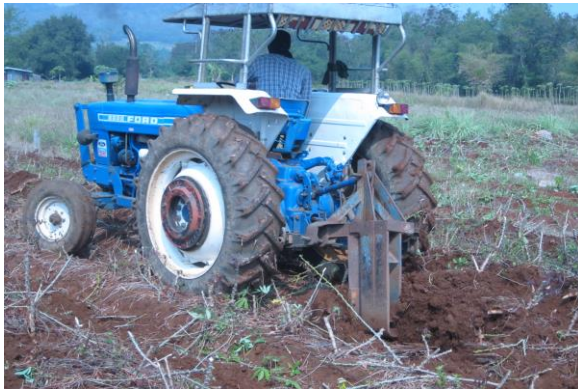
รูปที่ 3 ทดสอบวิธีการใช้เครื่องชุดมันสำปะหลังตามวิธีเกษตรกรกับวิธีการใช้แรงงานคนขุด
