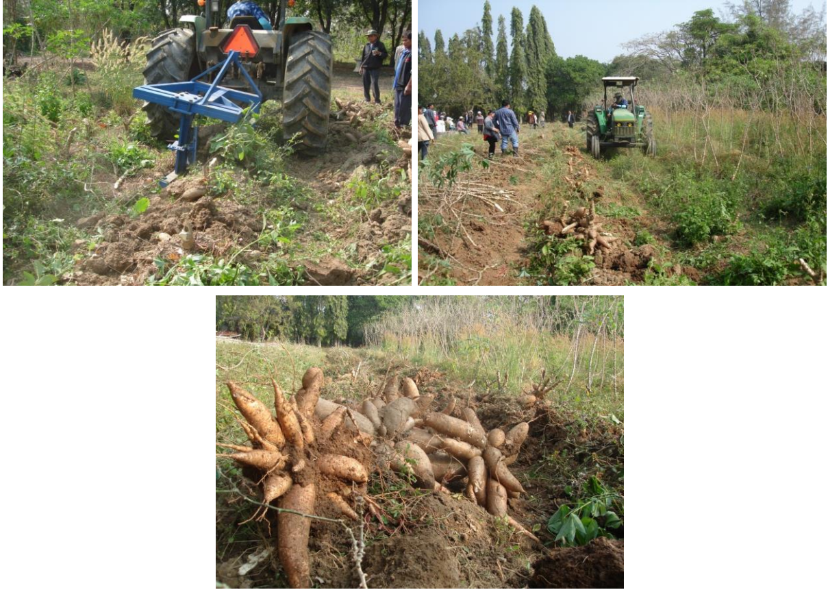
รูปที่ 1 ทดสอบการเครื่องชุดแบบไถหัวหมู ในพื้นที่นิคมสหกรณ์โป่งน้ำร้อน จันทบุรี ใช้รถแทรกเตอร์ขนาด 50 แรงม้า
