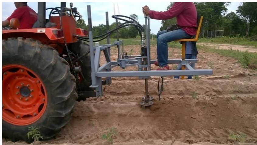
ภาพที่ 12 ทดสอบการทำงานเบื้องต้นของส่วนกำจัดวัชพืชระหว่างต้น
