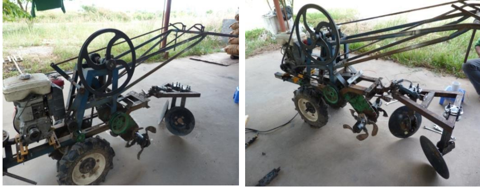
รูปที่ 7 ต้นแบบที่ 1 และรูปแบบใบผลัดไถแบบที่ 1 และ 2 เครื่องกำจัดวัชพืชในร่องมันสำปะหลังแบบเดินเดินตาม
