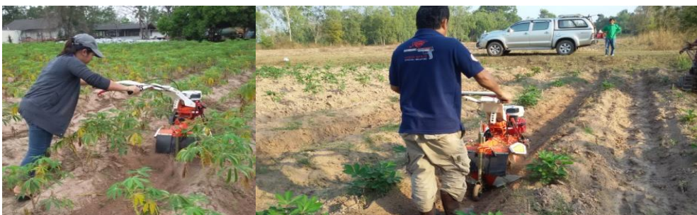
รูปที่ 4 การทดสอบเครื่องมือพรวนดินเพื่อหาแนวทางการออกแบบที่เหมาะสม
