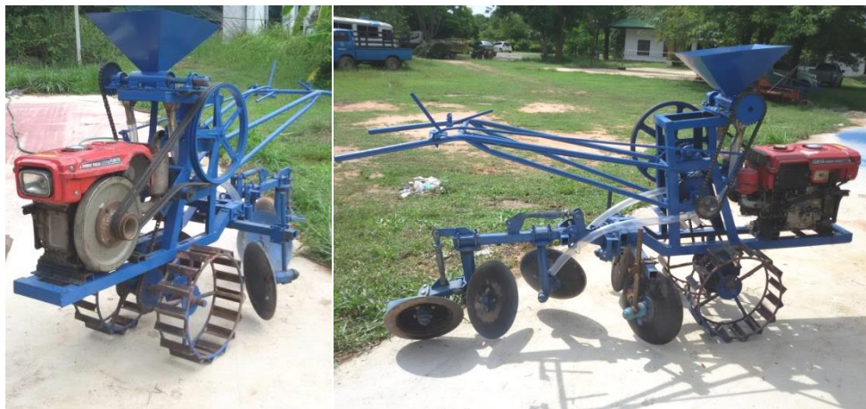
รูปที่ 13 ต้นแบบเครื่องกำจัดวัชพืชพร้อมกร่องกลบปุ๋ยในร่องมันสำปะหลังแบบเดินตาม
