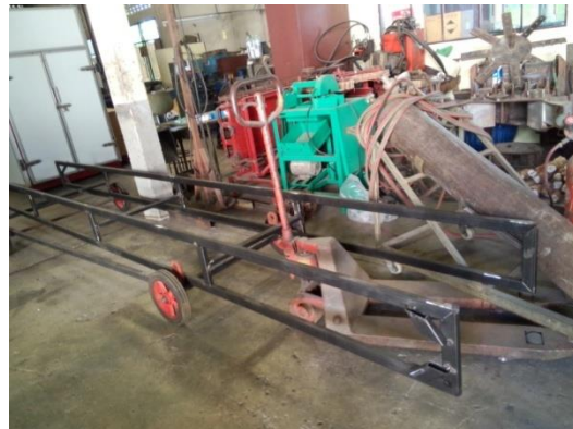
รูปที่ 4 สายพานลำเลียงที่จะใช้ในการทดสอบ (ก) และโครงสร้างของชุดสายพานลำเลียงที่อยู่ระหว่างการรอวัสดุสายพานในกระบวนการจัดซื้อ (ข)
