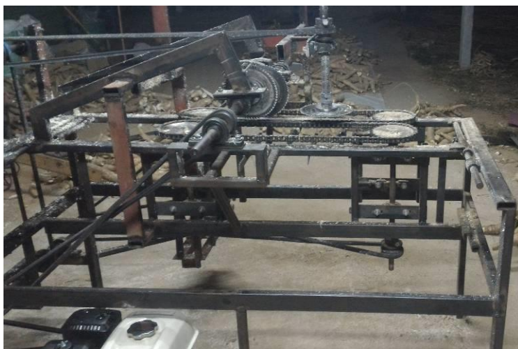
ภาพที่ 23 เครื่องต้นแบบที่ย้ายใบเลื่อยหลังมาด้านหน้า และกลับทิศการหมุนตัดใบเลื่อยด้านซ้าย
