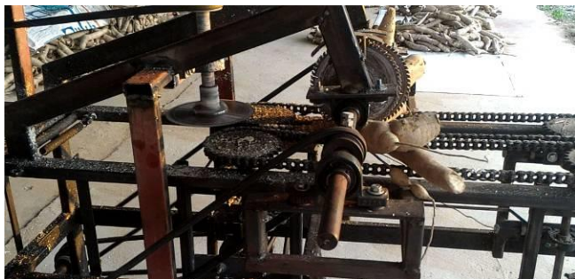
ภาพที่ 22 การติดตั้งของเครื่องต้นแบบที่ย้ายใบเลื่อยหลังให้อยู่ด้านบน
