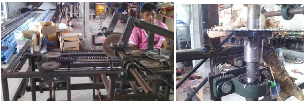
ภาพที่ 21 เครื่องต้นแบบที่ขยายโครงเครื่อง และใช้เครื่องยนต์ และการติดขัดของเหง้าที่ใบเลื่อยหลัง
