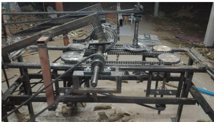
ภาพที่ 23 เครื่องต้นแบบที่ย้ายใบเลื่อยหลังมาอยู่ด้านหน้า ใบเลื่อยตัดข้างหมุนทิศเดียวกัน
