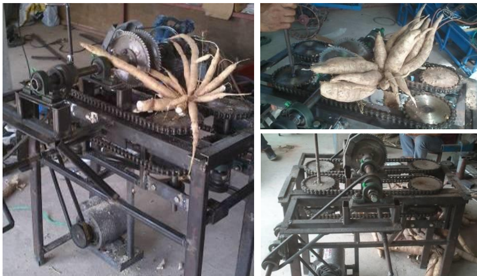
ภาพที่ 11 เครื่องต้นแบบแบบที่ 2 และลักษณะการวางเหง้ามันก่อนเข้าสู่การปลิดหัวมัน
