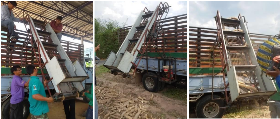
รูปที่ 8 การสร้างเครื่องมือขนย้ายและลำเลียงหัวมันสำปะหลัง
