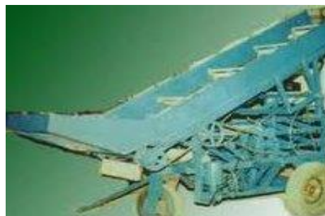
รูปที่ 7 เครื่องขนหัวมันสำปะหลังขึ้นรถบรรทุกแบบสายพานลำเลียง
