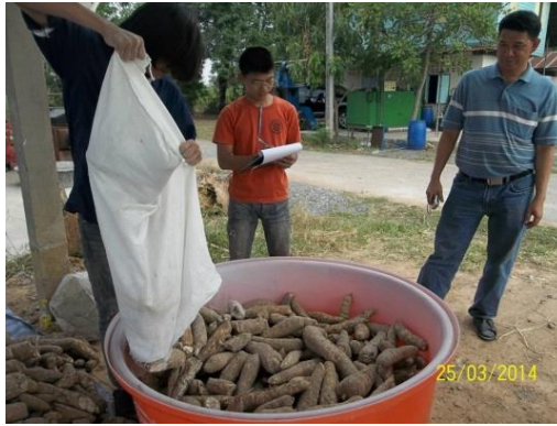
รูปที่ 6 การหาน้ำหนักต่อปริมาตรของหัวมัน (Bulk Density)
