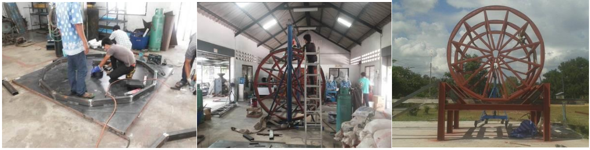
รูปที่ 16 การสร้างถังอบแห้งมันเส้นขนาดความจุ 5 ตันมันเส้นสด
