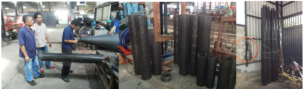
รูปที่ 17 การม้วนและเชื่อมต่อท่อลมถังอบแห้งมันเส้น
