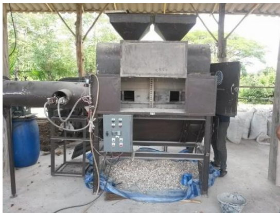
รูปที่ 11 การอบแห้งมันเส้นที่อุณหภูมิ 105 °C ด้วยเครื่องอบแห้งแบบโรตารี
