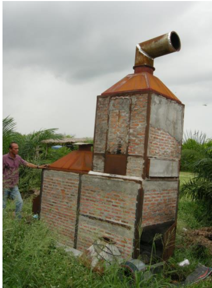
รูปที่ 19 เตาชีวมวลในการสร้างลมร้อนในการอบแห้ง
