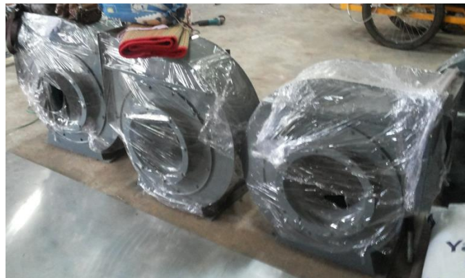
รูปที่ 18 พัฒนแบบแรงเหวี่ยงหนีศูนย์กลางสำหรับลมร้อนในการอบแห้ง
