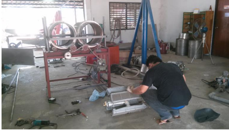
รูปที่12 การประกอบหัวเตาอินฟราเรดเข้าด้วยกัน
