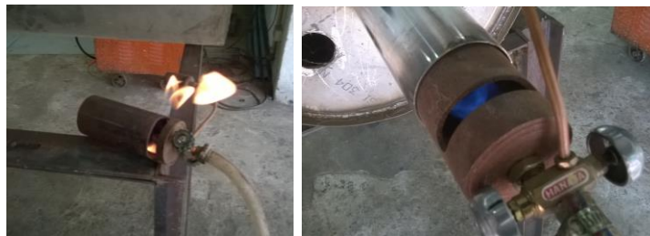
รูปที่7 หัวเผาแก๊สแอลพีจีแบบใช้ในตู้อบแบบอุโมงค์
