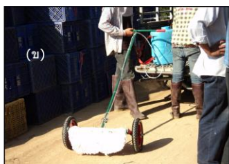
ภาพที่ 2 ต้นแบบเครื่องลูบวัชพืช 3 แบบ คือ ใช้ผ้าเช็ดเท้า (ก) ใช้ผ้า มีอบที่มีนริ้ว (ข) และลูกกลิ้งทาสี (ค)
