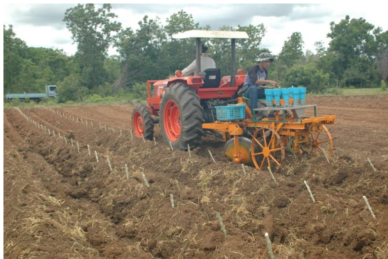
ภาพที่ 3 การทดสอบเครื่องปลูกมันสำปะหลังในสภาพดินร่วน
