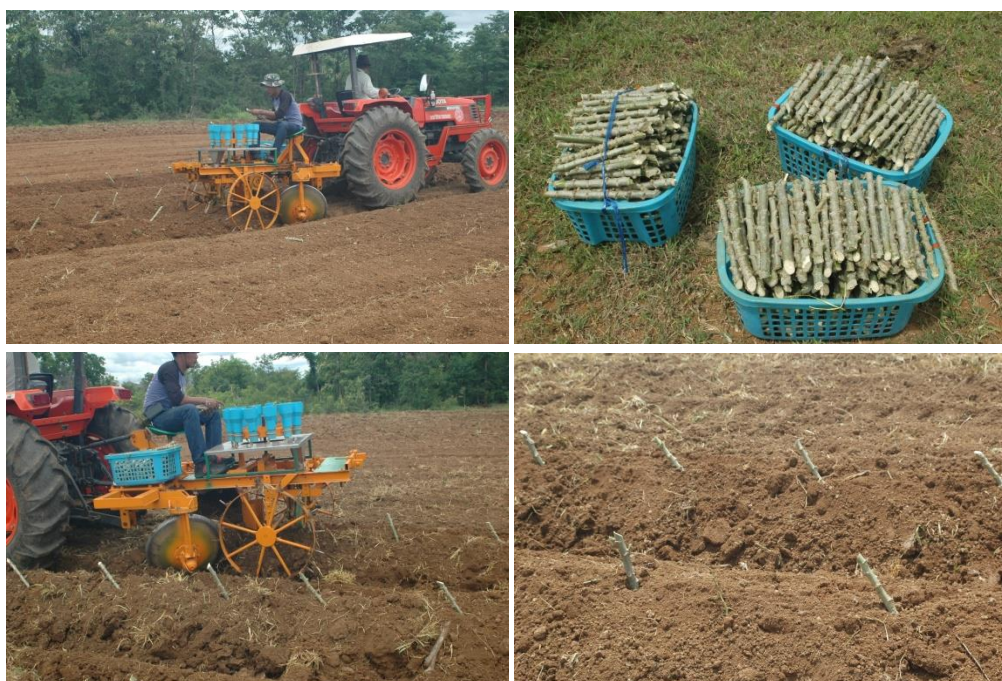
ภาพที่ 14 การทดสอบเครื่องปลูกมันสำปะหลังในดินร่วน
