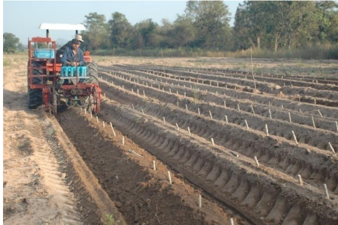
ภาพที่ 2 การทดสอบเครื่องปลูกมันสำปะหลังต้นแบบของสถาบันวิจัยเกษตรวิศวกรรม
