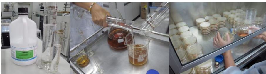
ภาพที่ 1 การเตรียมอาหารเลี้ยงเชื้อที่มีปริมาณน้ำอิสระแตกต่างกันโดยกลีเซอรอลและน้ำกลั่น
