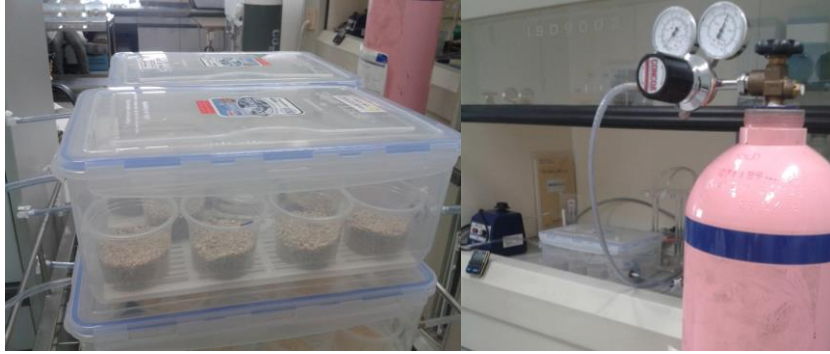
ภาพที่ 5 การทดสอบการเจริญของรา A. niger บนเมล็ดกาแฟภายใต้การจำลองสภาพอากาศ
