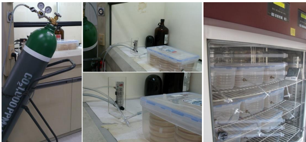
ภาพที่ 2 การเติม \text{CO}_2 ในกล่องเพื่อดัดแปลงสภาพบรรยากาศในการเลี้ยงเชื้อรา และการเก็บในตู้ควบคุมอุณหภูมิ
