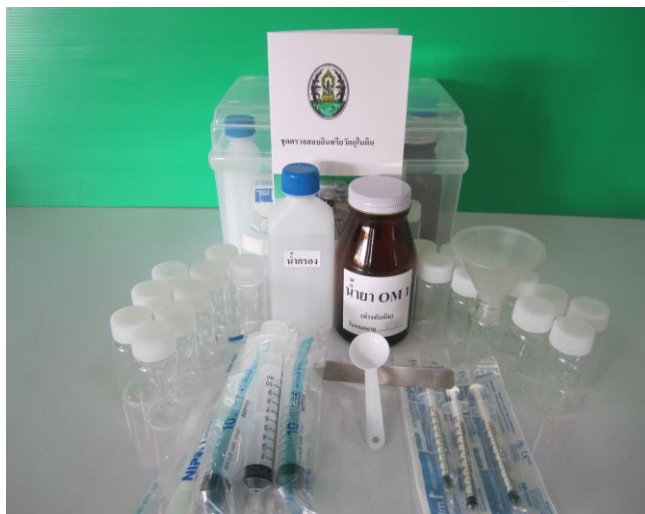
ภาพที่ 5 ชุดตรวจสอบอินทรีย์วัตถุในดินพร้อมคำแนะนำการใช้งาน
