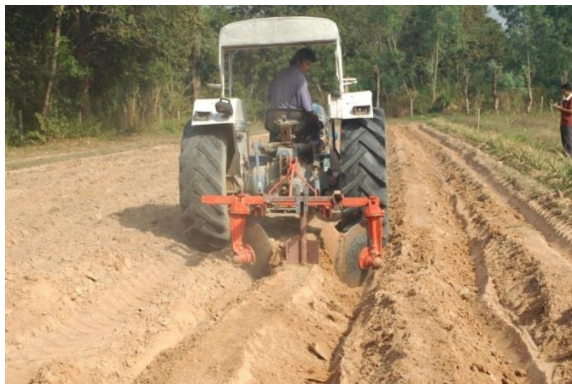
ภาพที่ 3.10 ทดสอบชุดพลาถกร่อง
