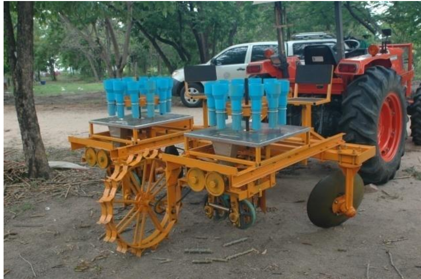
ภาพที่ 3.22 เครื่องปลูกมันสำปะหลังพวงท้ายรถแทรกเตอร์แบบ 2 แถว
