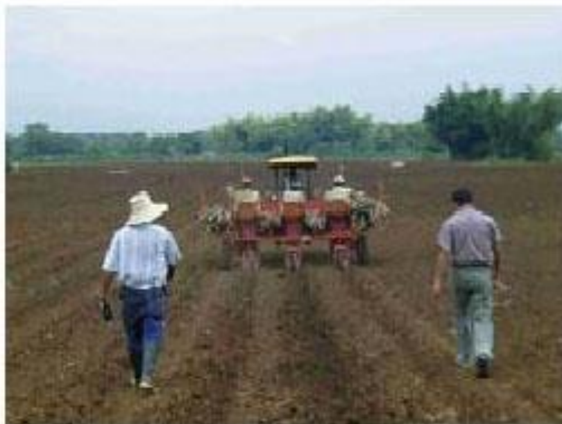
ภาพที่ 3.8 เครื่องปลูกมันสำปะหลังแบบ 3 แถว
