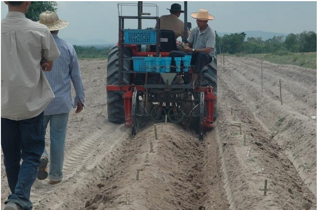
ภาพที่ 3.15 การทดสอบเครื่องปลูกมันสำปะหลังหลังปรับปรุง
