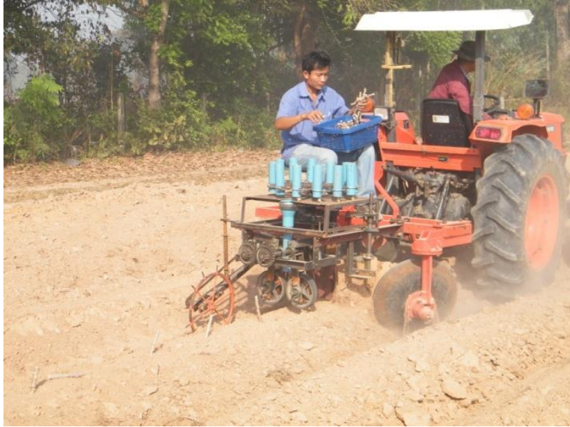
ภาพที่ 3.11 ทดสอบการทำงานเครื่องปลูกมันสำปะหลังเบื้องต้น
