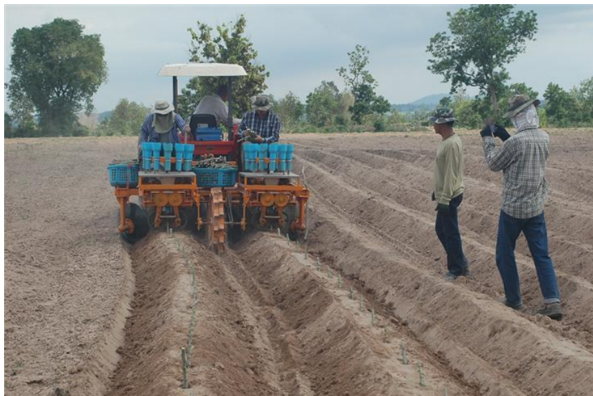
ภาพที่ 3.23 ทดสอบเครื่องปลูกมันสำปะหลังแบบ 2 แถว
