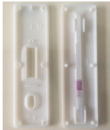
ภาพที่ 21 แสดงภาพการประกอบ Strip test กับ กั๊บตลับพลาสติก
