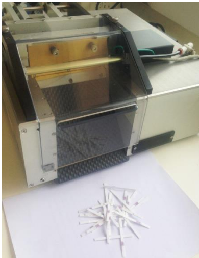
ภาพที่ 20 แสดงภาพการตัด Strip test ที่ประกอบเสร็จแล้วด้วยเครื่อง Bio Dot
