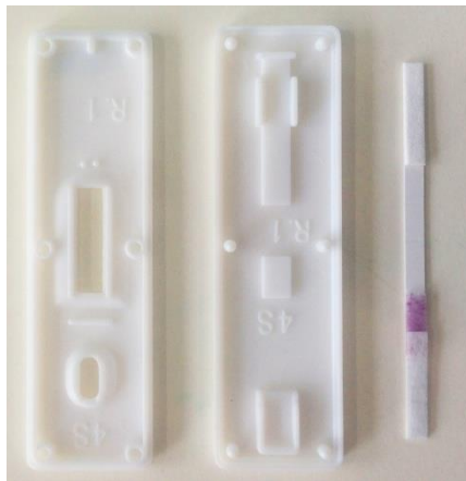
ภาพที่ 21 แสดงภาพการประกอบ Strip test กับ กั๊บตลับพลาสติก
