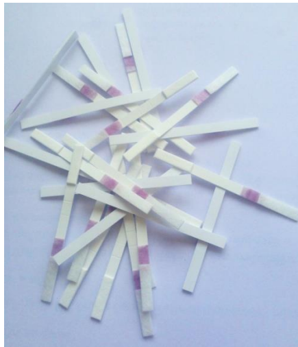
ภาพที่ 20 แสดงภาพการตัด Strip test ที่ประกอบเสร็จแล้วด้วยเครื่อง Bio Dot
