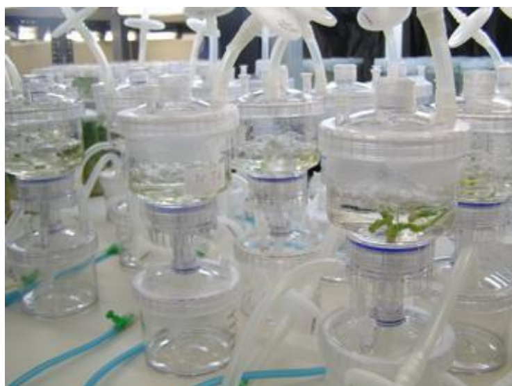
ภาพที่ 4 การศึกษาระยะเวลาและจำนวนครั้งในการให้อาหารเหลวเนื้อเยื่อกระถือที่เพาะเลี้ยงในระบบเหมโพรารีไบโอรีแอกเตอร์ ในภาพเห็นอาหารเหลวถูกแรงลมดันขึ้นไปอยู่ในกระบอกอันบนที่มีเนื้อเยื่อกระถืออยู่
