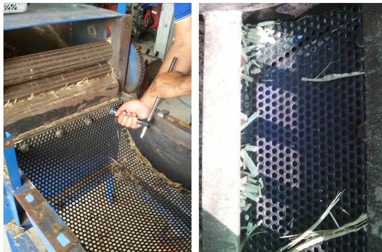
ภาพที่ 19 การเปลี่ยนขนาดรูตะแกรงของเครื่องหั่นย่อย
