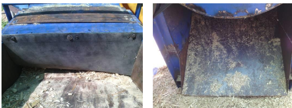
ภาพที่ 21 ติดตั้งแผ่นยางกันฝุ่นย้อนกลับ และถาดรองรับวัสดุใต้ตะแกรงเหล็ก
