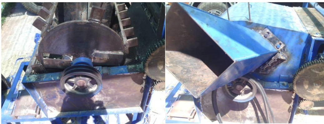
ภาพที่ 20 การเสริมชุดใบมีดที่ 1 ให้มีความแข็งแรงและมีหน้าสัมผัสการตัดเฉือนมากขึ้น
