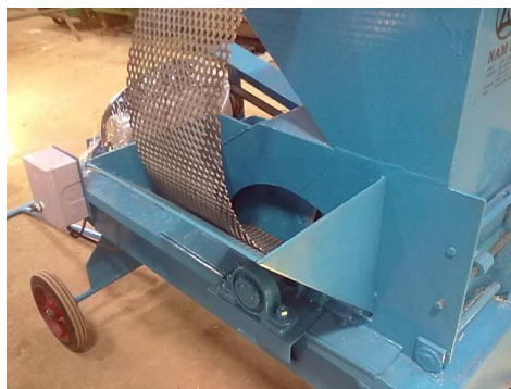
ภาพที่ 4 เครื่องสับย่อยพืชเส้นใย และมีระบบบด (Hammer Mill) ในเครื่องเดียวกัน
