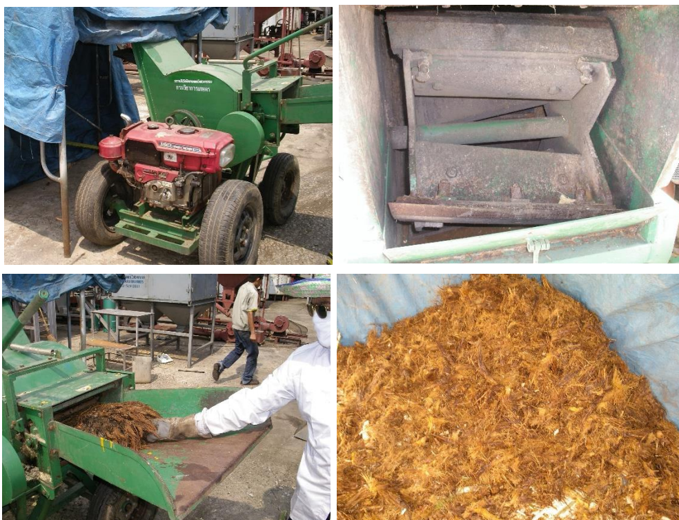
ภาพที่ 9.6 การสับย่อยทะลายปาล์มด้วยเครื่องสับแบบหัวสับชนิดทรงกระบอกและขนาดขึ้นหลังการสับ
