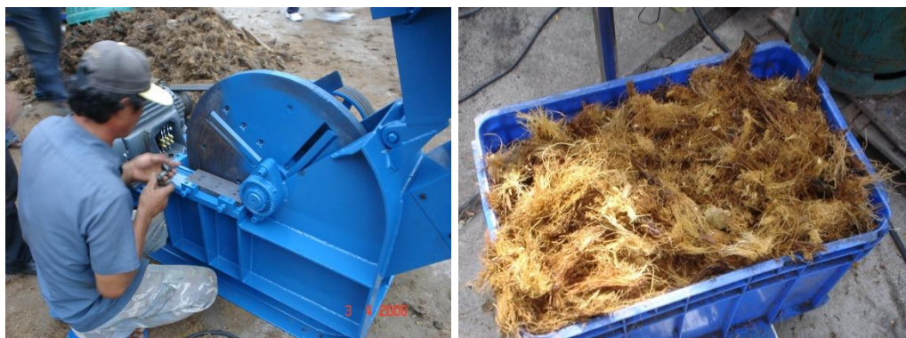
ภาพที่ 9.5 การสับย่อยทะลายปาล์มด้วยเครื่องสับแบบหัวสับชนิดจานกลมขนาดใหญ่และขนาดขึ้นหลังการสับ
