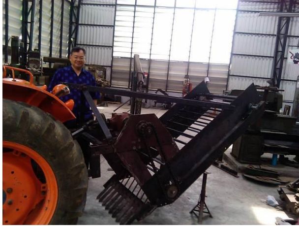
ภาพที่ 11 เครื่องเก็บเหง้ามันสำปะหลังติดท้ายรถแทรกเตอร์ใช้ชุดเก็บเป็นซี่เหล็ก ส่งขึ้นสายพานโซ่ลำเลียง
