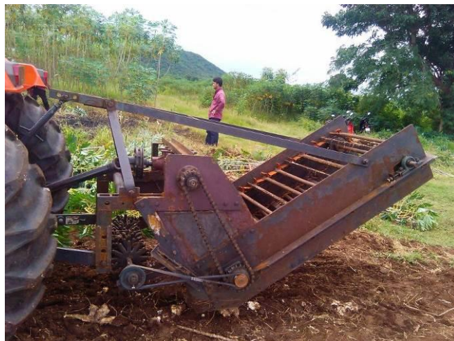
ภาพที่ 13 เครื่องเก็บเห้งน้ำมันสำปะหลังติดท้ายรถแทรกเตอร์ใช้หัวเก็บแบบผลจานครึ่งซีกเดียว ส่งขึ้นสายพานโซ่ลำเลียง
