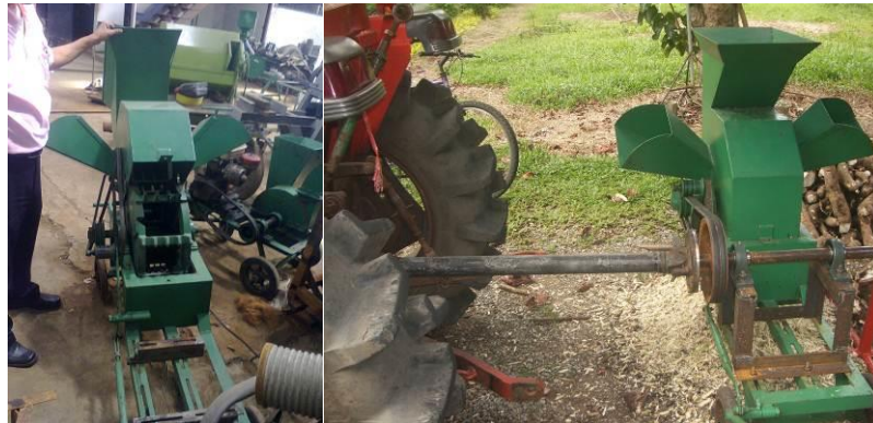
ภาพที่ 17 เครื่องเครื่องย่อยเหง้ามันสำปะหลัง ของสถาบันวิจัยเกษตรวิศวกรรม กรมวิชาการเกษตร สรุปผลการวิจัยและข้อเสนอแนะ
