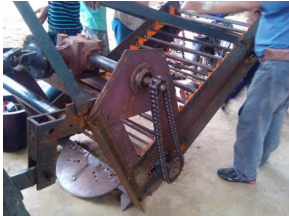
ภาพที่ 13 เครื่องเก็บเห้งน้ำมันสำปะหลังติดท้ายรถแทรกเตอร์ใช้หัวเก็บแบบผลจานครึ่งซีกเดียว ส่งขึ้นสายพานโซ่ลำเลียง
