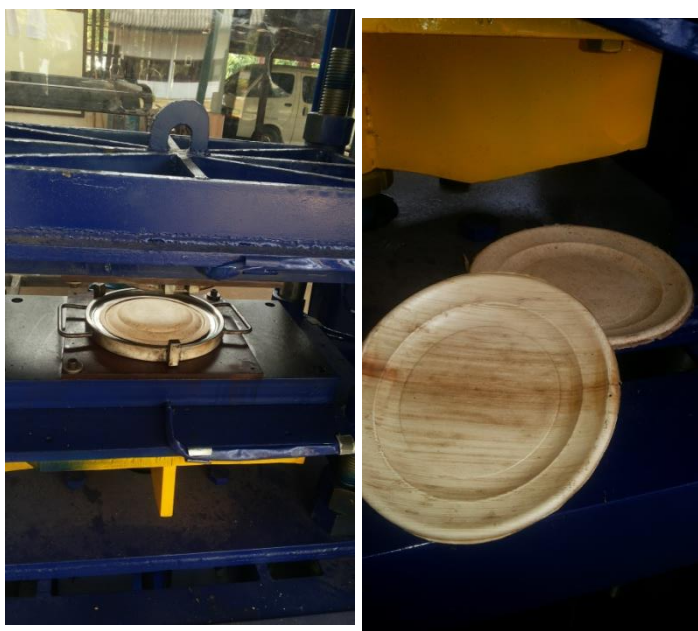
รูปที่ 7 การอัดขึ้นรูปงานโดยเครื่องต้นแบบขึ้นรูปบรรจุภัณฑ์ชีวภาพ และบรรจุภัณฑ์ที่ได้
