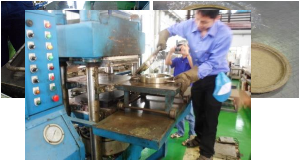
รูปที่ 2 การอัดทดสอบโดยใช้เครื่องอัดขึ้นรูปยางแผ่น ของสถาบันวิจัยยาง กรมวิชาการเกษตร
