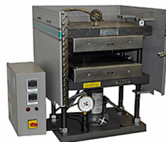
รูปที่ 1 เครื่องมือที่ใช้เพื่ออัดแบบแห้ง(Dry pressing)สำหรับการอัดขึ้นรูป ที่มีการใช้ในปัจจุบัน
