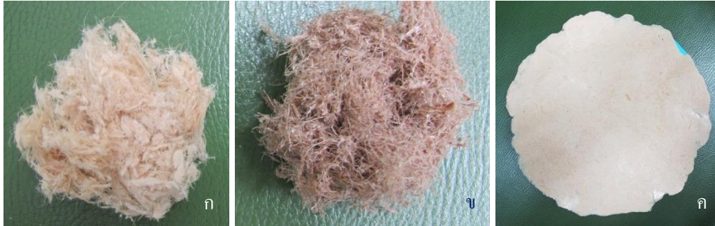
ภาพที่ 12 (ก /ข) เยื่อจากก้านข้าวและเหง้าข้าวที่เหลือจากการสกัด (ค) กระดาษที่ได้จากกากข้าว
