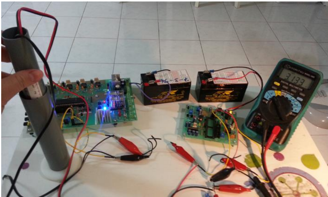
รูปที่ 2 การทดสอบหัวเซ็นเซอร์รับส่งแสงอินฟราเรด
