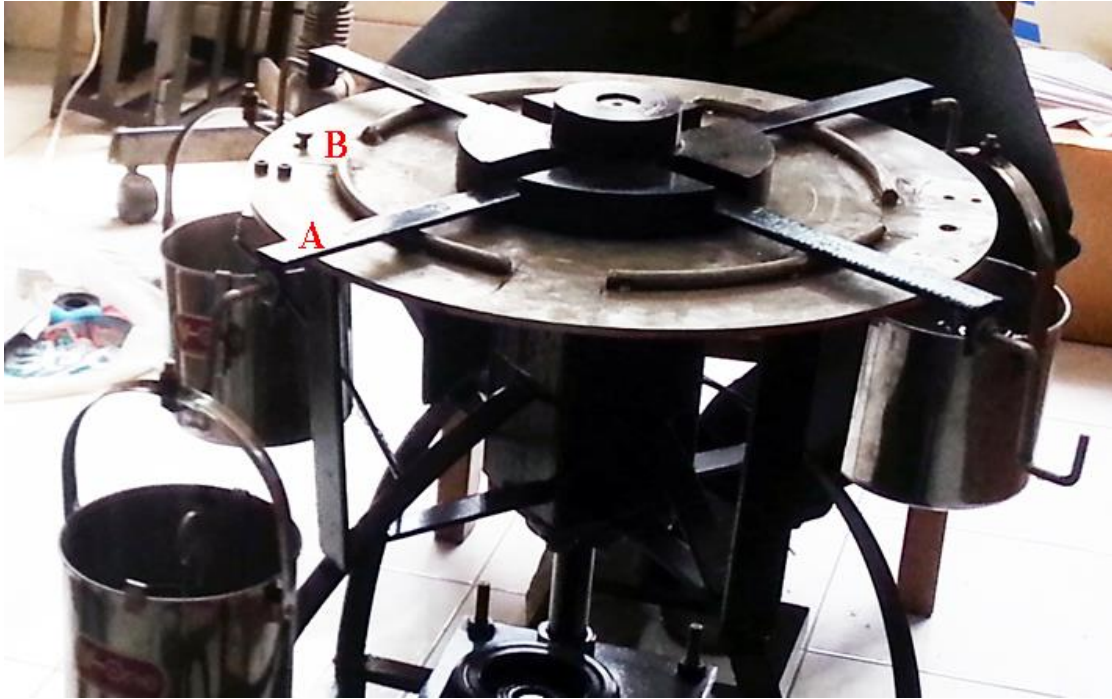
รูปที่ 4 อุปกรณ์ส่งถ่ายน้ำหนัก; (A) คานรับน้ำหนัก, (B) เต็ยรับน้ำหนักต่อกับโหลดเซล
