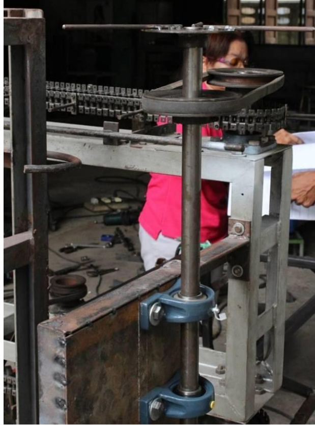
รูปที่ 9 ส่วนการโน้มเกี่ยวต้นมันสำปะหลังเพื่อให้สู่การการตัด และลำเลียง
