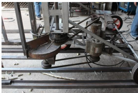
รูปที่ 6 ระบบส่งกำลังขับเคลื่อนชุดใบมีด (ซ้าย) และชุดลำเลียงต้นออกด้านข้าง(ขวา)
