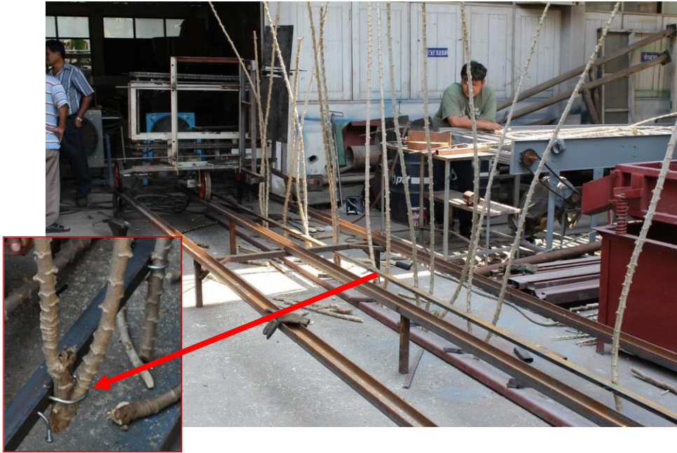
รูปที่ 7 รางวิ่งของชุดทดสอบ และการจับยึดต้นมันสำปะหลังสำหรับการทดสอบ
