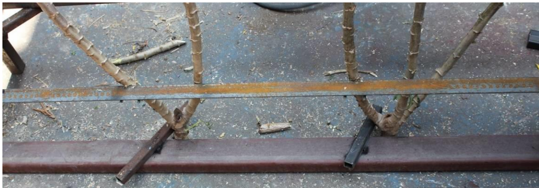
รูปที่ 8 การแก้ปัญหาการจับยึดต้นมันสำปะหลัง จากยึดจุดเดียวต่อต้น เป็นยึดสองจุดต่อต้น
