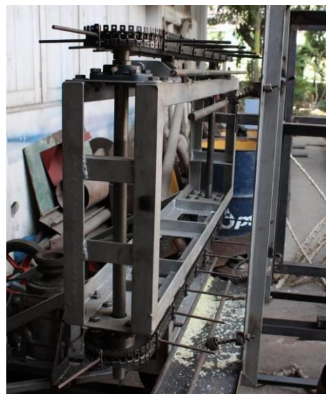
รูปที่ 5 ส่วนของชุดตัด (ซ้าย) และชุดลำเลียง (ขวา)
