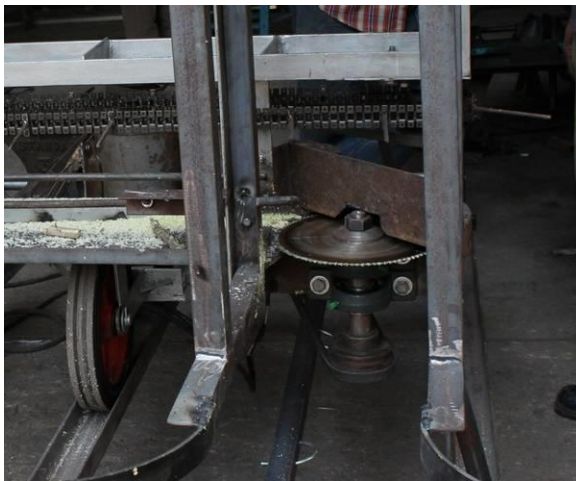
รูปที่ 5 ส่วนของชุดตัด (ซ้าย) และชุดลำเลียง (ขวา)
