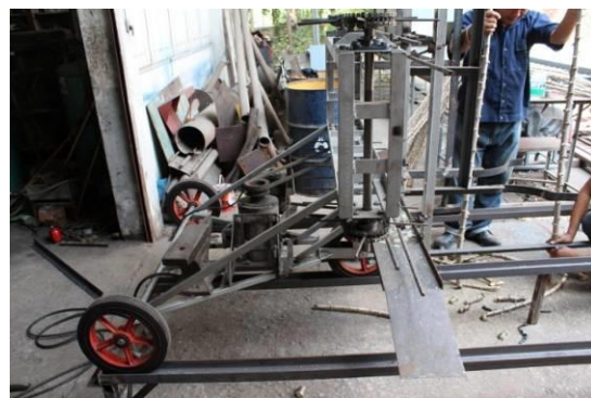
รูปที่ 6 ระบบส่งกำลังขับเคลื่อนชุดใบมีด (ซ้าย) และชุดลำเลียงต้นออกด้านข้าง(ขวา)
