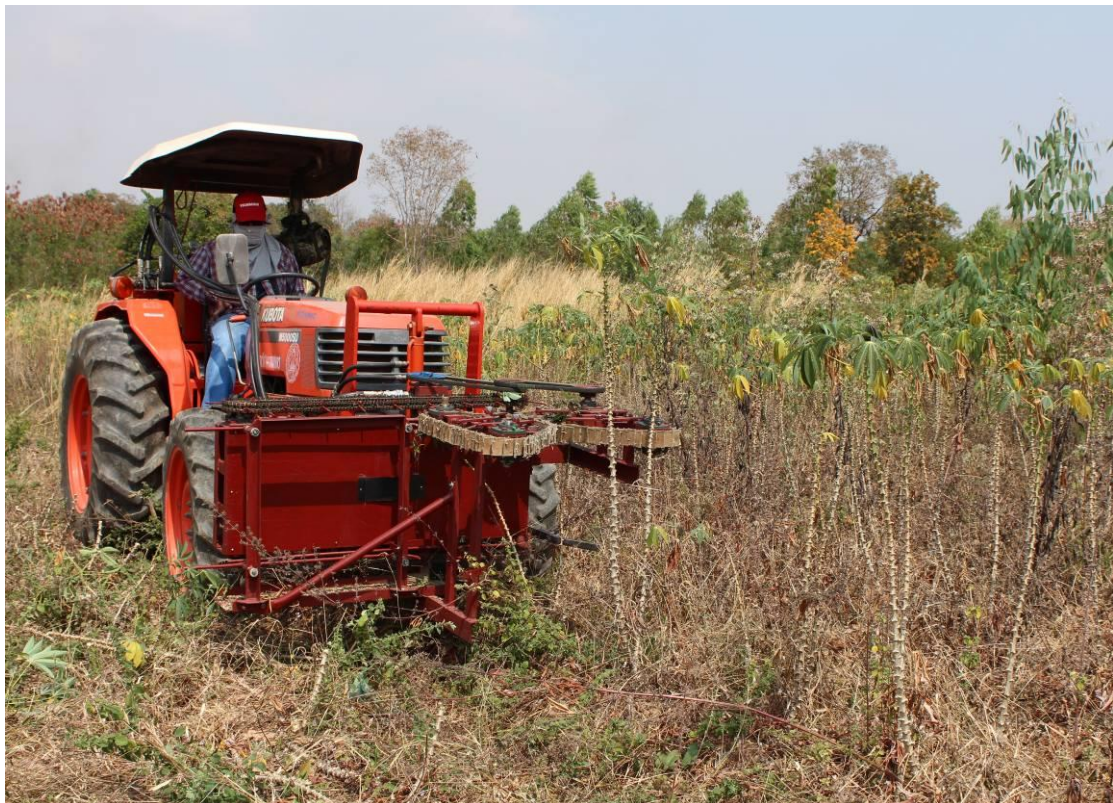
รูปที่ 13 ทดสอบตัดต้นมันสำปะหลังพันธุ์ระยอง 9 อายุเก็บเกี่ยว 8 เดือน
