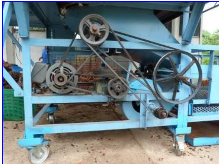
ภาพที่ 8 ชุดควบคุมการทำงานมอเตอร์ไฟฟ้า และการหมุนสลับทิศทางของจานหมุน
