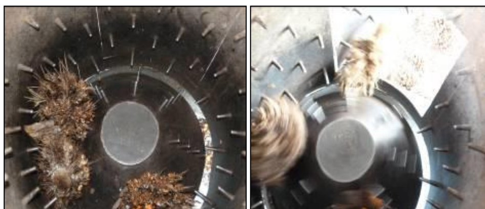
ภาพที่ 12 ลักษณะภายในถังแยกของเครื่องขณะทำการผลิตผลออกจากทะเลายปาล์มน้ำมัน
