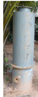
ภาพที่ 4 ส่วนการอบแห้ง ไพโรไลซิส และช่วงเผาไหม้
