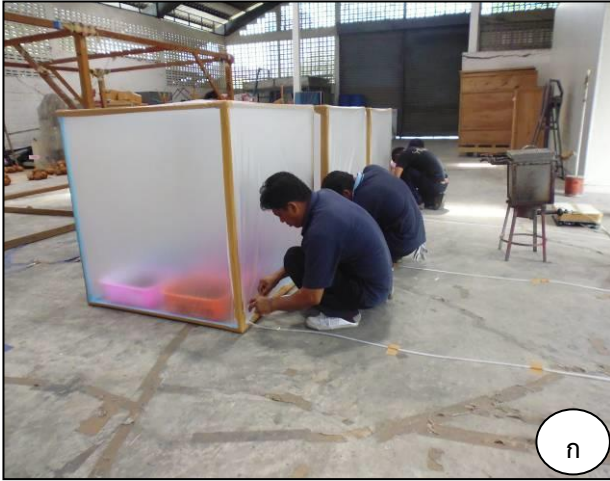
ภาพที่ ๓ การรมยาฆ่าแมลงด้วยเมทิลโบรไมด์เพื่อตรวจสอบการประสิทธิภาพการกำจัดมด และ เพลี้ยแป้ง
