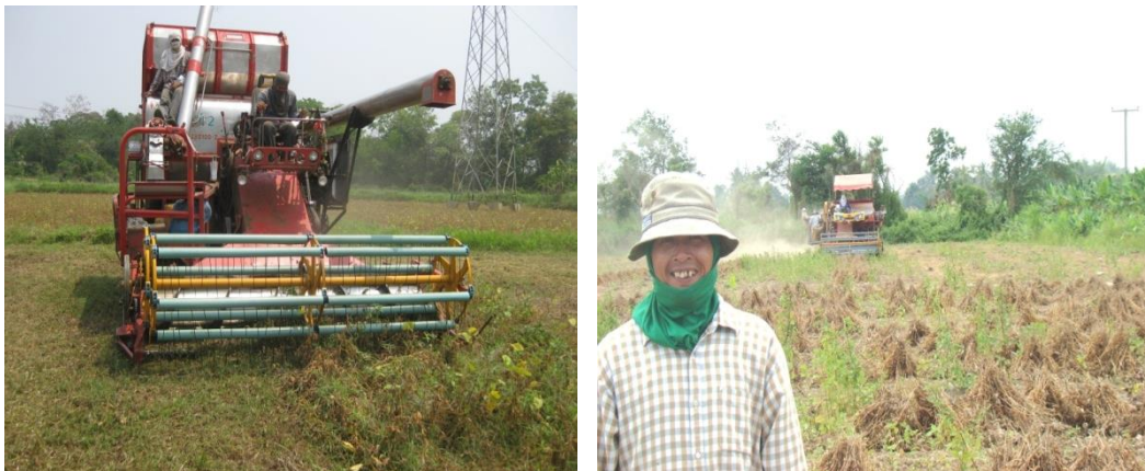
ภาพที่ 2 การทดสอบเครื่องเกี่ยวขนาดเมล็ดพันธุ์ถั่วเหลืองขนาด 8 ตัน
