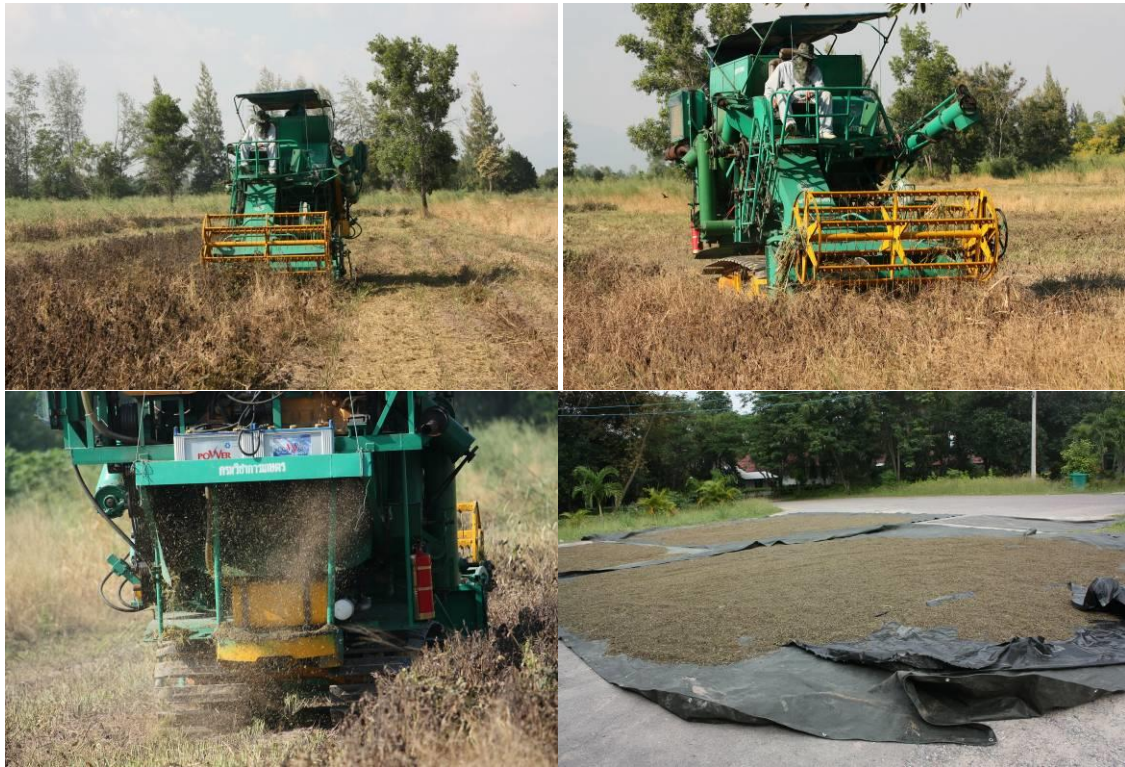
ภาพที่ 9 ทดสอบเครื่องเกี่ยวนวดข้าวในสภาพการใช้งานระยะยาวในแปลงทดสอบ
