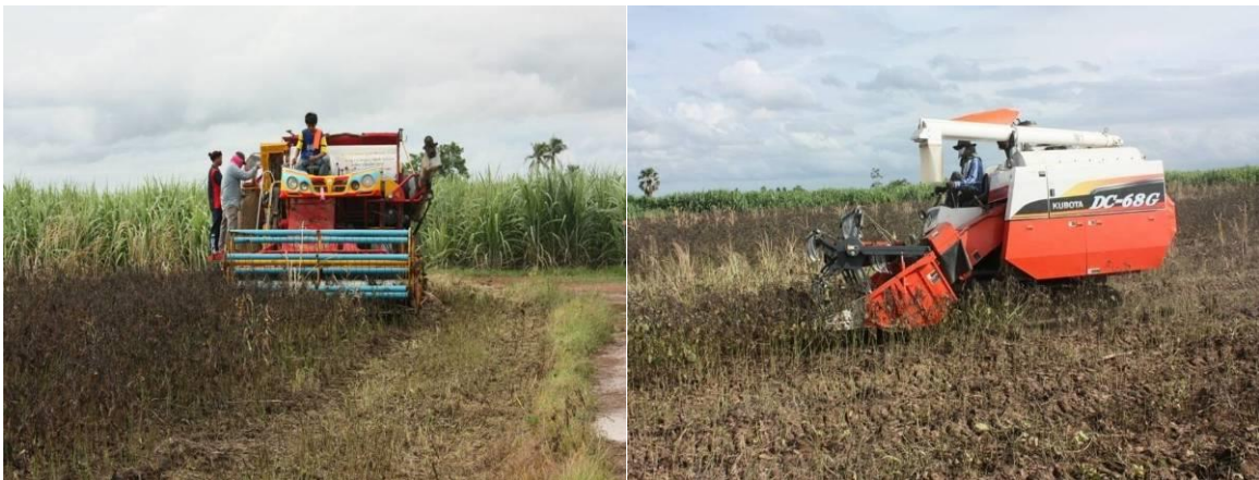
ภาพที่ 1 การใช้เครื่องเกี่ยวขนาดเก็บเกี่ยวข้าวสภาพต้นแห้งในแปลงที่พ่นสารเคมีก่อนเก็บเกี่ยว
