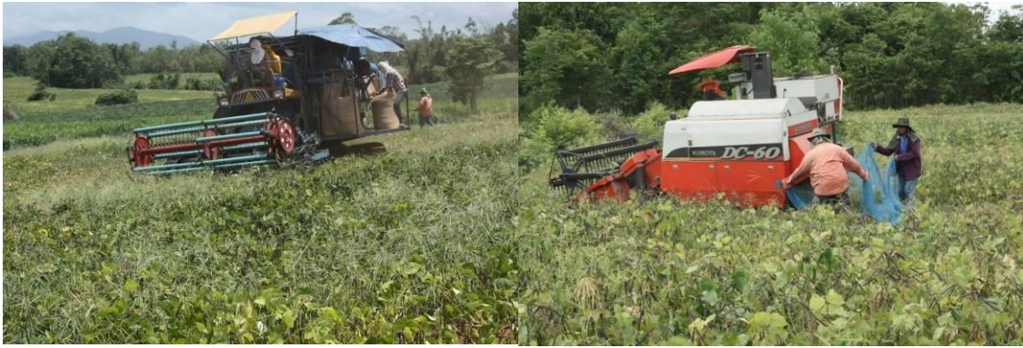
ภาพที่ 2 การใช้เครื่องเกี่ยวขนาดเก็บเกี่ยวถั่วเขียวต้นสดในแปลงที่ไม่ผ่านการพ่นสารเคมี
