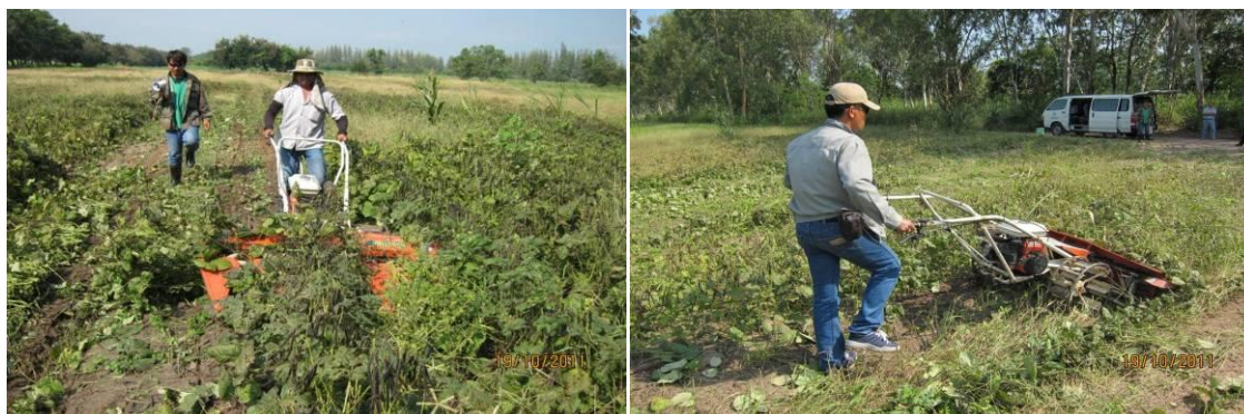
ภาพที่ 6 การทดสอบการเก็บเกี่ยวถั่วเขียวด้วยเครื่องเกี่ยววางราย
