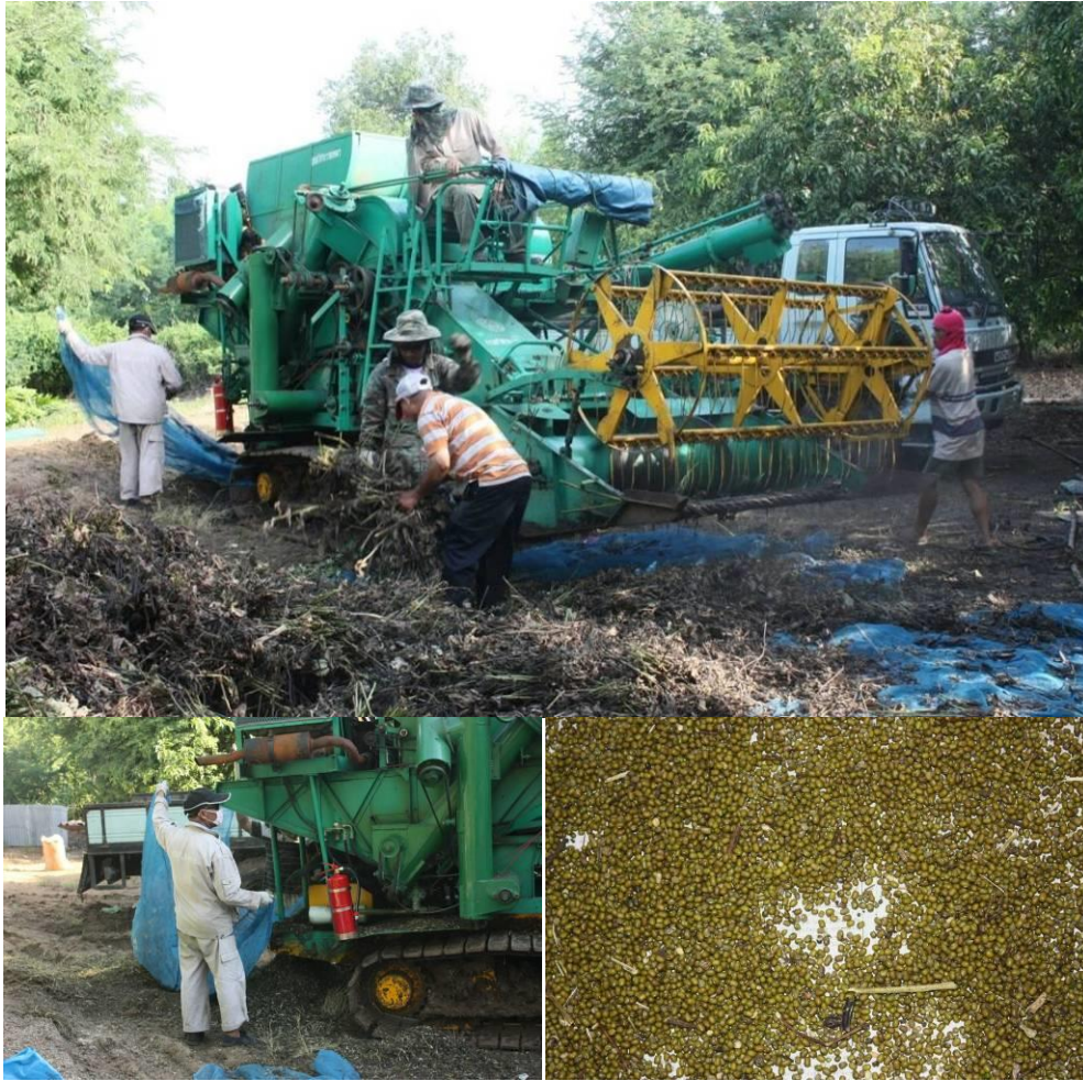
ภาพที่ 5 การทดสอบระบบขนาดและระบบตัดทำความสะอาดของต้นแบบเครื่องเกี่ยวนวดถั่วเขียว ที่เก็บเกี่ยวด้วยแรงงานคนโดยพ่นยากรัสมือกโซน ก่อนเก็บเกี่ยว 4 วัน
