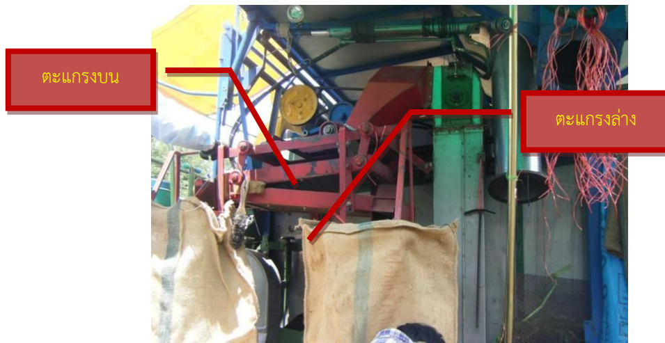
ภาพที่ 3 ตำแหน่งที่ติดตั้งเพิ่มเติมของตะแกรงคัดสำหรับเกี่ยวขนาดถั่วเขียว
