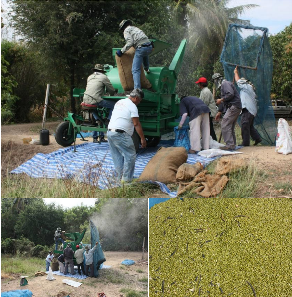
ภาพที่ 4 การทดสอบเครื่องกะเทาะฝักข้าวเขียว ที่เก็บเกี่ยวด้วยแรงงานคนโดยไม่พ่นยาก่อนเก็บเกี่ยว
