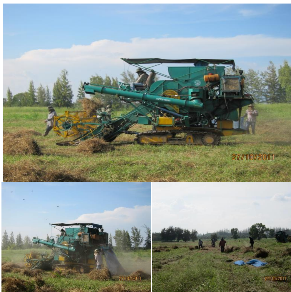
ภาพที่ 7 ทดสอบเครื่องเกี่ยวขนาดสำหรับนวดถั่วเขียวทั้งต้นที่เก็บเกี่ยวด้วยเครื่องเกี่ยววางราย
