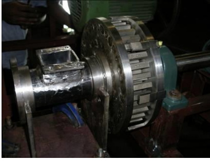
ภาพที่ 11 แสดงลักษณะการประกอบทำงานของจานบด ภาพที่ 12 ตะแกรงละเอียดครอบจานบด
