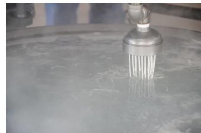
ภาพที่ 9 ลักษณะเส้นที่โรยออกมา มีการขาดเป็นบางช่วง
